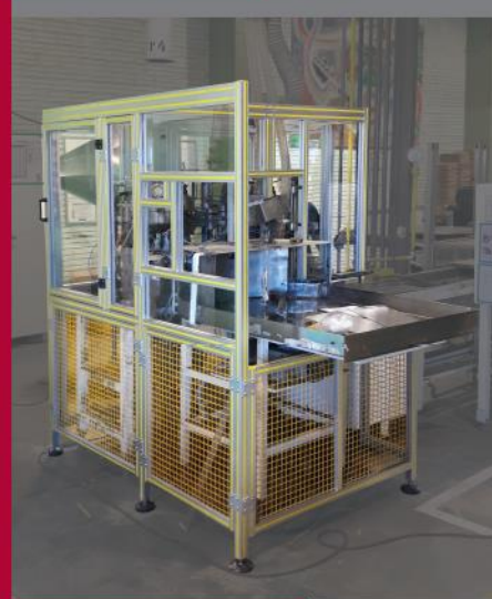
Proteção de abastecedor
